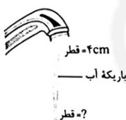
۸. فرض کنید مطابق شکل شیر آبی را باز کرده و آب به آرامی جربان یابد. اگر تندی خروج آب از دهانه شیر  $5 \text{ cm/s}$  و شعاع سطح مقطع نوک شیر آب  $2 \text{ cm}$  و تندی باریکه آب در نقطه‌ای در نزدیکی زمین  $20 \text{ cm/s}$  شود، قطر باریکه آب در نزدیکی زمین چند سانتی‌متر است؟ (۱.۵ نمره)
